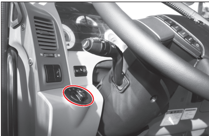
کلید چراغ‌ها در بخش پایین و سمت چپ غربیلک فرمان قرار دارد.
