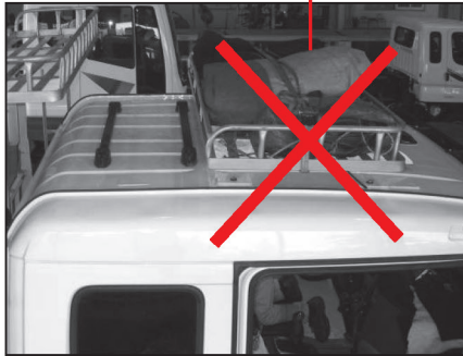
نمونه - موقعیت اشتباه (استفاده از سوراخ نصب بوق بادی)
